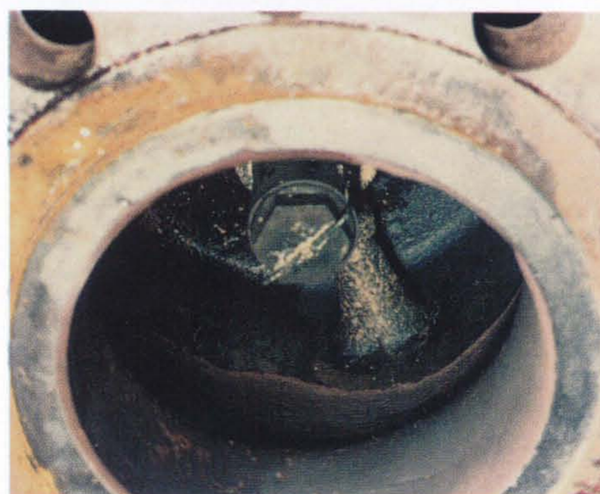
Bild 7: Ausbildung geschlossener Schutzschichten durch ODA-Konditionierung (oben) im Vergleich zu ODA-freiem Wasserregime (unten)
