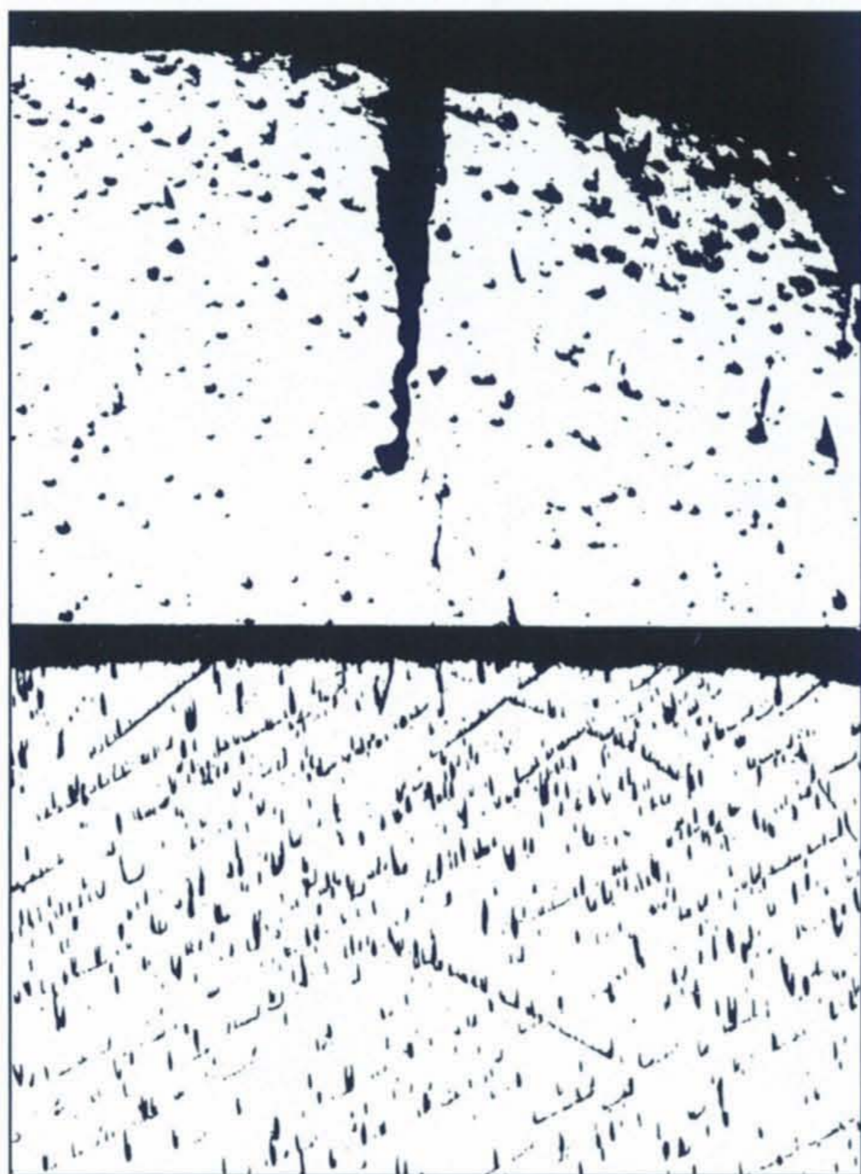
Bild 5: Schliffbilder austenitischer Proben, die bei 523 K und einer Chloridkonzentration von 10 g/l ohne (oben) und mit ODA (unten) exponiert wurden
