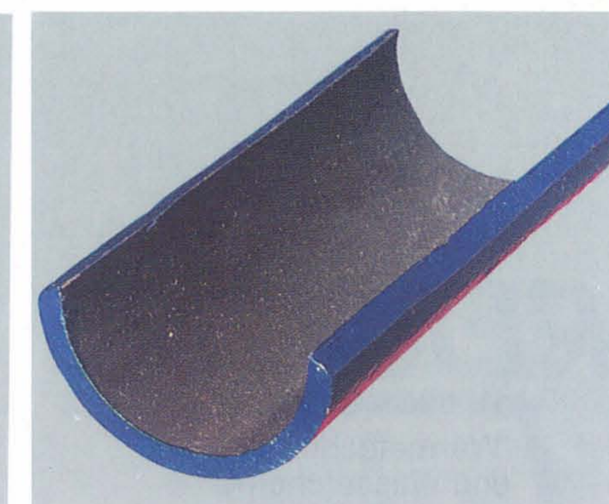
Abb. 4: Verdampferrohr nach der Reinigung
